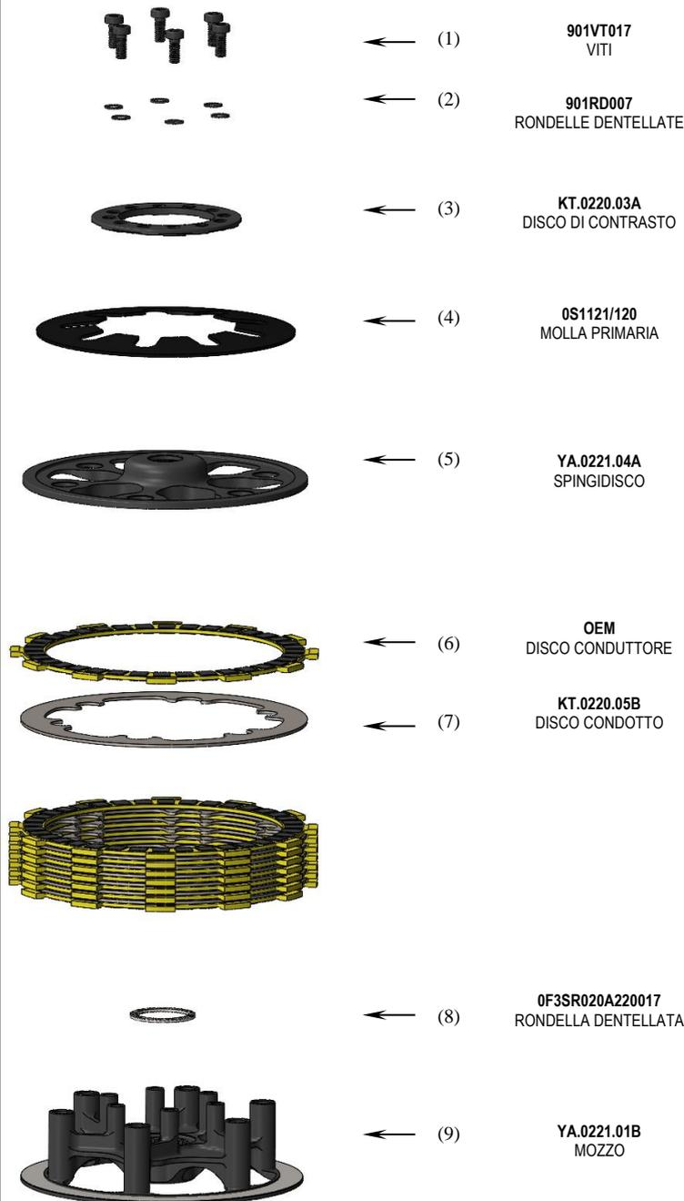
Il funzionamento della frizione è strettamente correlato all'altezza del pacco dischi. E' necessario dunque misurare il pacco dischi prima del montaggio. Dalla frizione originale prelevare solo i dischi conduttori, quindi assemblare il pacco dischi utilizzando i dischi condotti (7) forniti nella confezione ed effettuare la misurazione.
