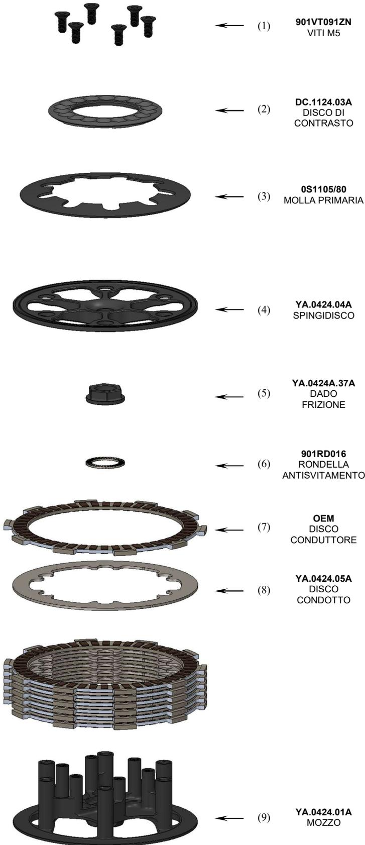
Il funzionamento della frizione è strettamente correlato all'altezza del pacco dischi. È necessario dunque misurare il pacco dischi prima del montaggio. Dalla frizione originale prelevare solo i dischi conduttori, quindi assemblare il pacco dischi utilizzando i dischi condotti (8) forniti nella confezione ed effettuare la misurazione.
