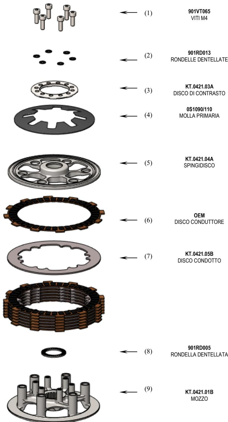
Il funzionamento della frizione è strettamente correlato all'altezza del pacco dischi. E' necessario dunque misurare il pacco dischi prima del montaggio. Dalla frizione originale prelevare solo i dischi conduttori, quindi assemblare il pacco dischi utilizzando i dischi condotti (7) forniti nella confezione ed effettuare la misurazione.
