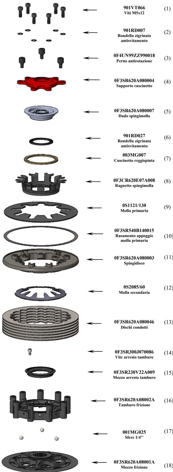
Il gruppo mozzo/tamburo, viene fornito pre-assemblato. **IN CASO DI NECESSITA'**, per eseguire un controllo dello stato delle rampe, seguire la PROCEDURA SMONTAGGIO GRUPPO MOZZO/TAMBURNO indicata più in basso.
