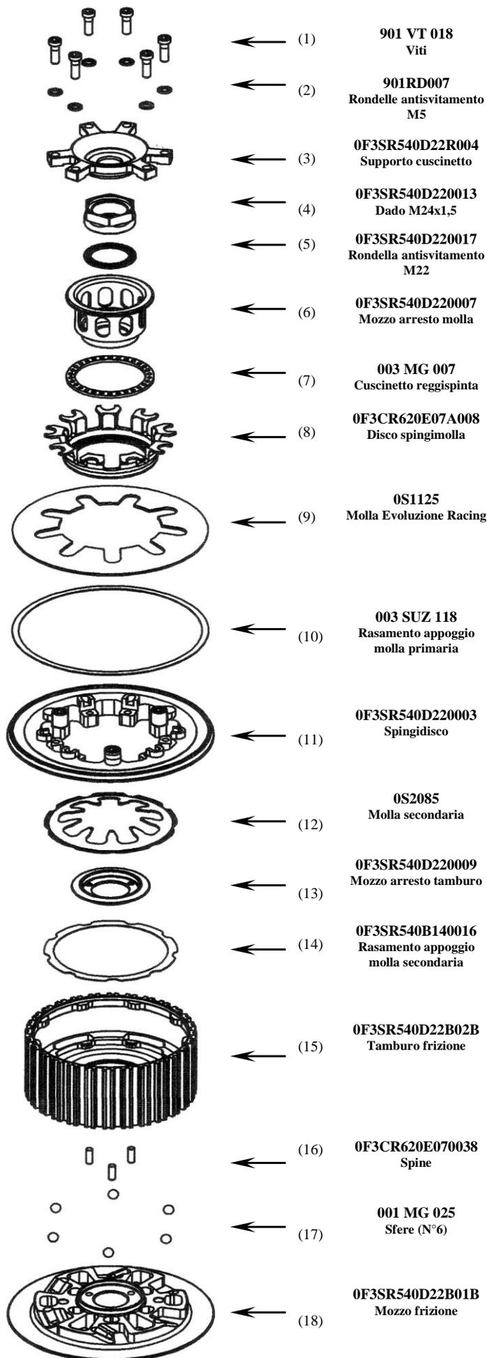
Premontare il gruppo mozzo: collocare le 6 sfere (17) al fondo delle scanalature del mozzo (18) applicando una piccola quantità di grasso, quindi con una vite M6x1 fissare il tamburo (15) sul mozzo (18) in posizione di riposo.
