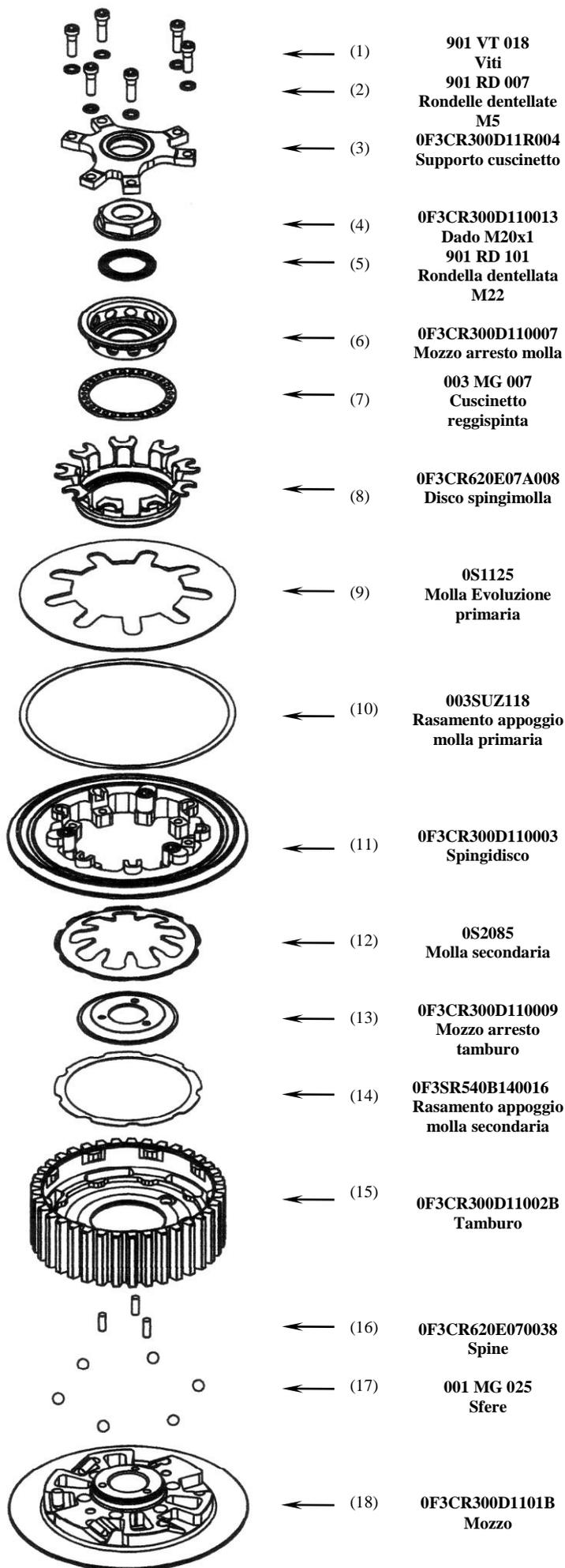
Eseguire il premontaggio del gruppo mozzo: collocare le 6 sfere (17), al fondo delle scanalature del mozzo (18), con una piccola quantità di grasso. Quindi fissare con una vite M6x1, il tamburo (15) sul mozzo (18) in posizione di riposo.
