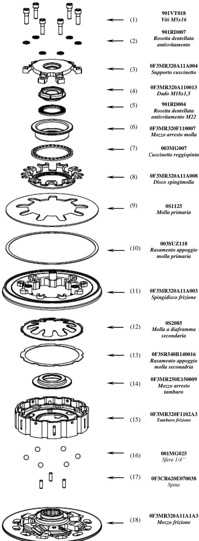
Eseguire il premontaggio del gruppo mozzo: collocare le 6 sfere (16), al fondo delle scanalature del mozzo (18) applicando una piccola quantità di grasso.
