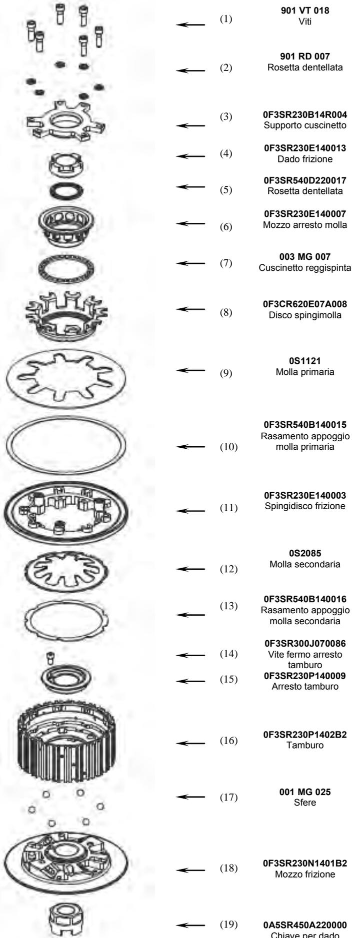
Il gruppo mozzo/tamburo, viene fornito pre-assemblato. **IN CASO DI NECESSITA'**, per eseguire una ispezione dello stato delle rampe, seguire la PROCEDURA SMONTAGGIO GRUPPO MOZZO/TAMBURO indicata più in basso.
