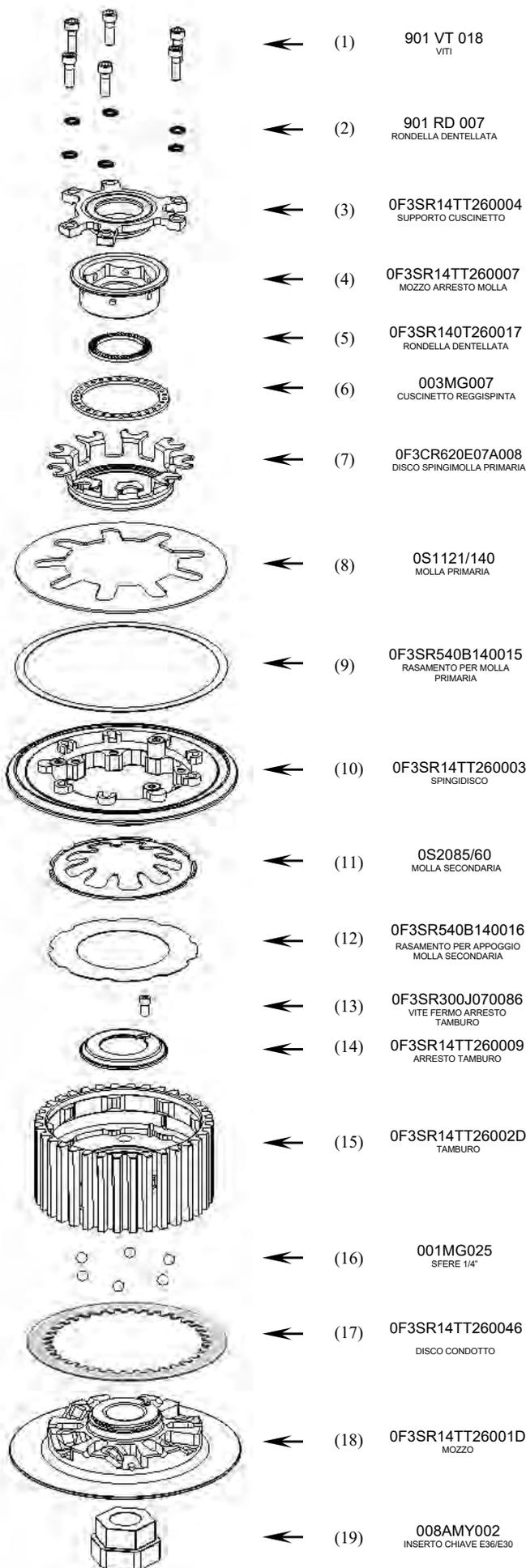
Il gruppo mozzo/tamburo viene fornito pre-assemblato. **IN CASO DI NECESSITA'**, per eseguire una ispezione dello stato delle rampe, seguire la PROCEDURA SMONTAGGIO GRUPPO MOZZO/TAMBURO indicata più in basso.
