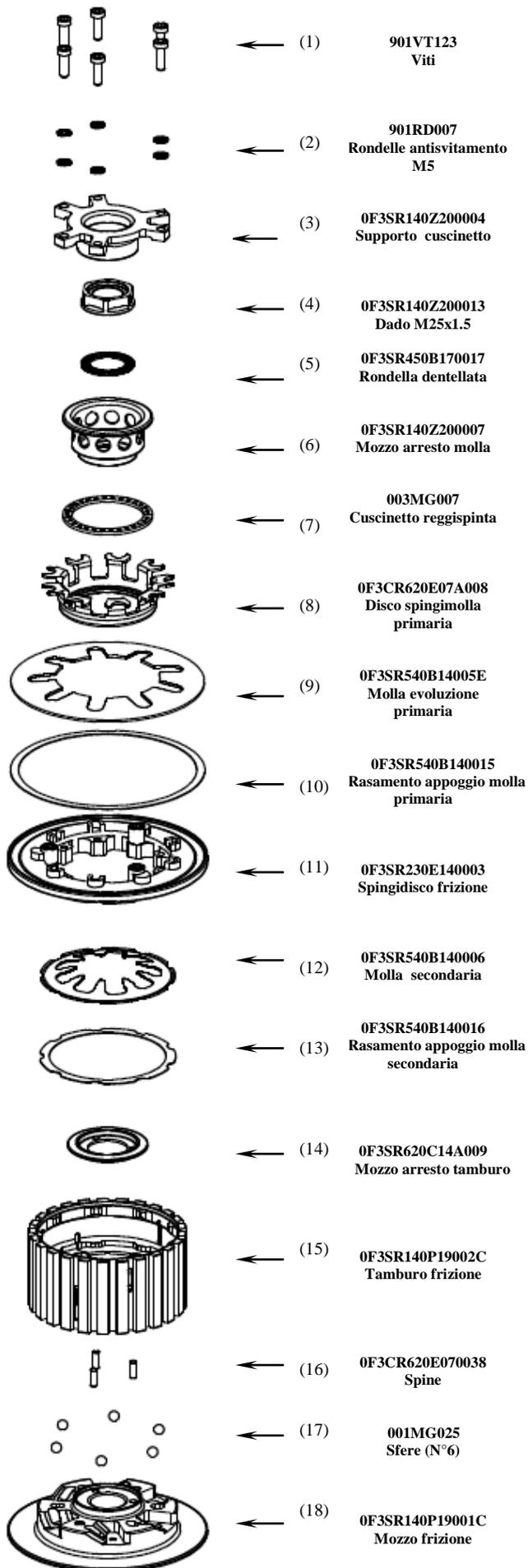
Eseguire il premontaggio del gruppo mozzo: posizionare il mozzo (18), quindi collocare le N° 6 sfere (17), al fondo delle scanalature, con una piccola quantità di grasso. Quindi aiutandosi con una vite M6x1 fissare il tamburo (15), sul mozzo in posizione di riposo.
